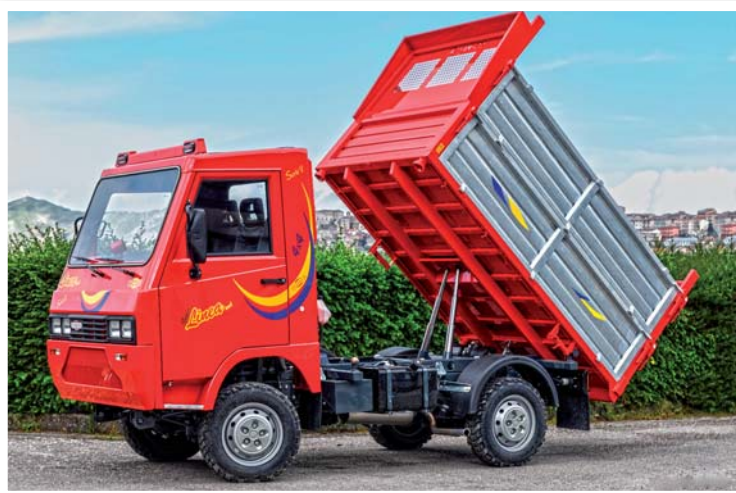
Nosiče FORT řady PANTERA, LINEA (foto) a MITHOS mají dvoumístnou kabinu a nářadí se agreguje většinou na rám
