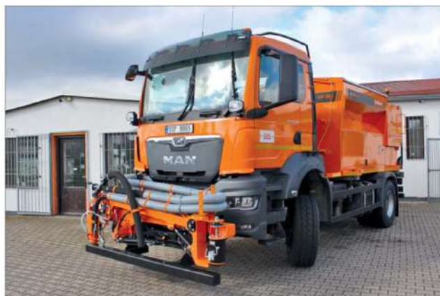
Na podvozku MAN bude pracovat turbo vysprávková souprava STRASSMAYR STP 100S/4000 Joy
